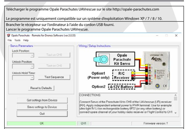
La barre de statut située en bas à gauche de la fenêtre doit être verte (connexion OK).
