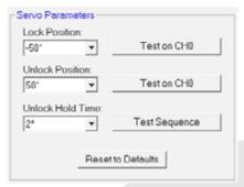
Le paramètre "Lock Position" permet d'ajuster la position du servomoteur lorsque le système est à l'état repos. C'est à dire, lorsqu'il n'y a pas d'ordre reçu de la radiocommande pour déployer le parachute. La position du palonnier du servomoteur verrouille la tige d'armement avec la goupille:
