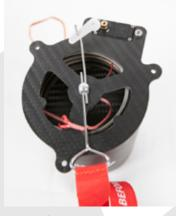
Pour vérifier la position du palonnier, cliquer sur "Test on CH0". Celui ci se placera sur la valeur définie. A ajuster en fonction de la position désirée.
