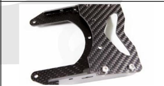
Monter ensuite les deux haubans à l'aide de vis CHC M3-12 et rondelles M3.
