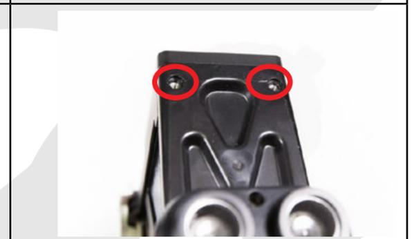
Positionner le support et le fixer à l'aide de 2 autres vis torx (plus longue) préalablement prélevées sur le hauban de l'inspire.
