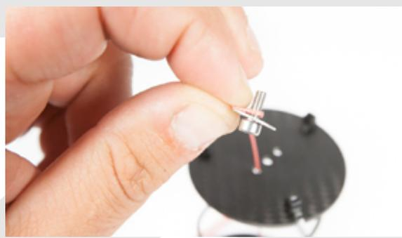
Insérer la vis avec la suspente dans le trou central du piston
