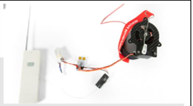
En position éjection, l'angle formé doit être de -45°. La goupille libère complètement la tige d'armement.
