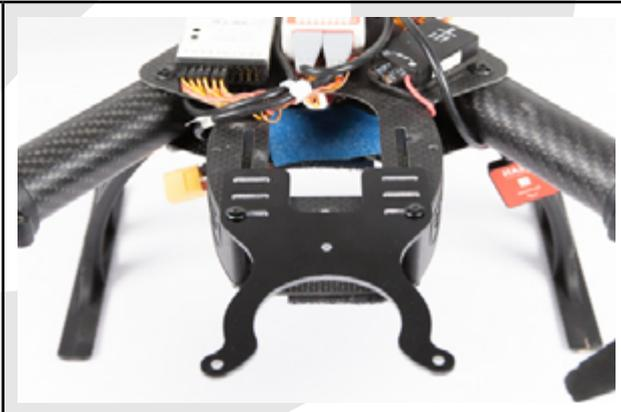
Utiliser 3 vis CHC M3-10 avec écrous freins M3 pour fixer le tube sur le support.
