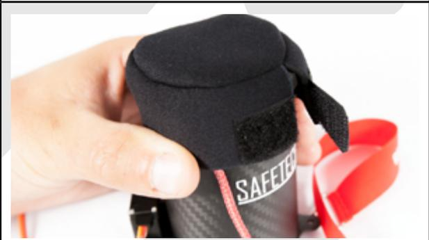
Ne jamais disposer la suspenste de fixation à travers le capuchon
