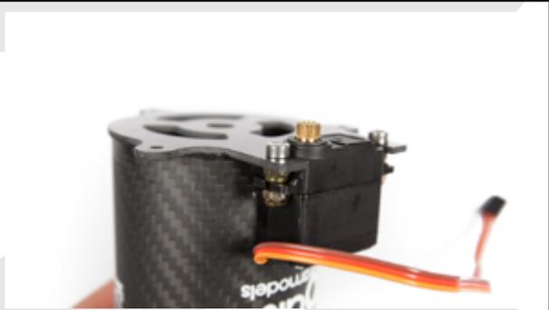
Utiliser le palonnier horizontale (les autre palonniers fournis dans le sachet du servomoteur ne seront pas utilisés).
